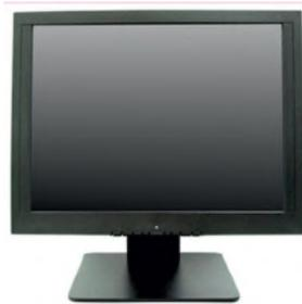
Tamaño de pantalla: 15 pulgadas. Resolución: XGA 1024 x 768. Contraste: 450:1. Brillo: 250 cd/m2. Tiempo de respuesta: 16 ms. Ángulos de visión Horizontal/Vertical: 140°/130° Dos posiciones (Vertical y horizontal)
